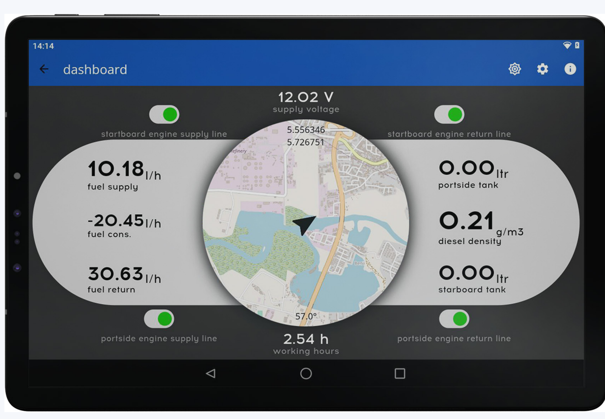
Lorsque l'application est connectée à Internet, les mécaniciens peuvent suivre la consommation de carburant des bateaux en temps réel
