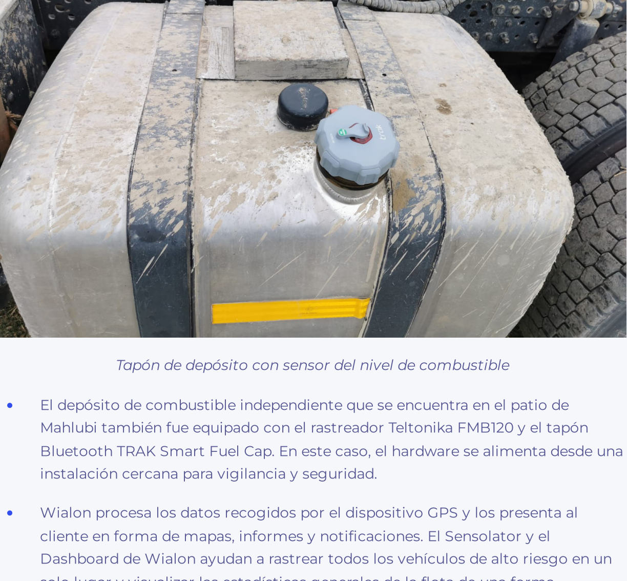
Tapón de depósito con sensor del nivel de combustible
