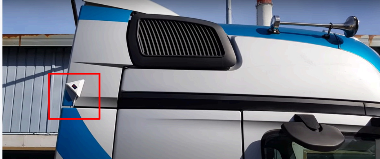
Um sensor infravermelho de movimento na cabine mirado para o tanque de combustível
