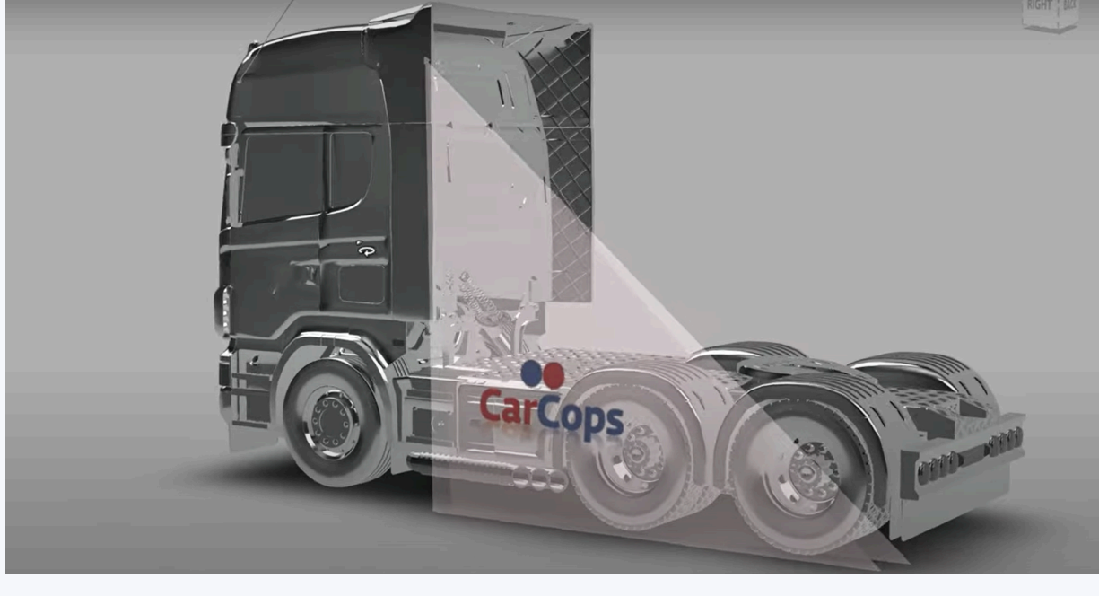
Uma simulação gráfica 3D da cortina infravermelha invisível
