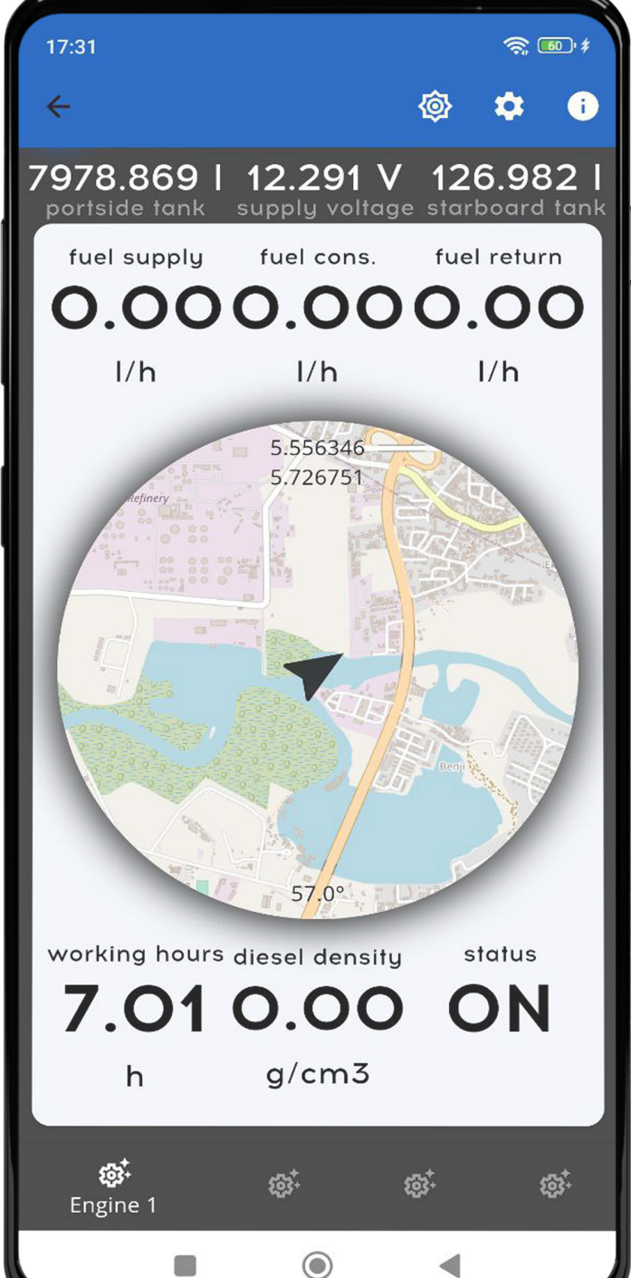
Aplicación móvil para el control de combustible en buques
