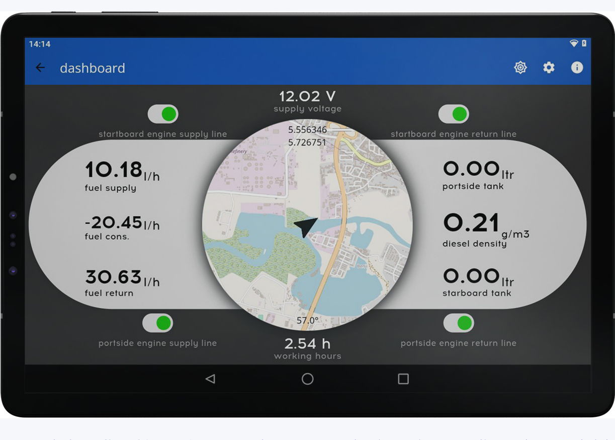
Cuando la aplicación está conectada a Internet, los ingenieros realizan el control del consumo de combustible de los buques en tiempo real
