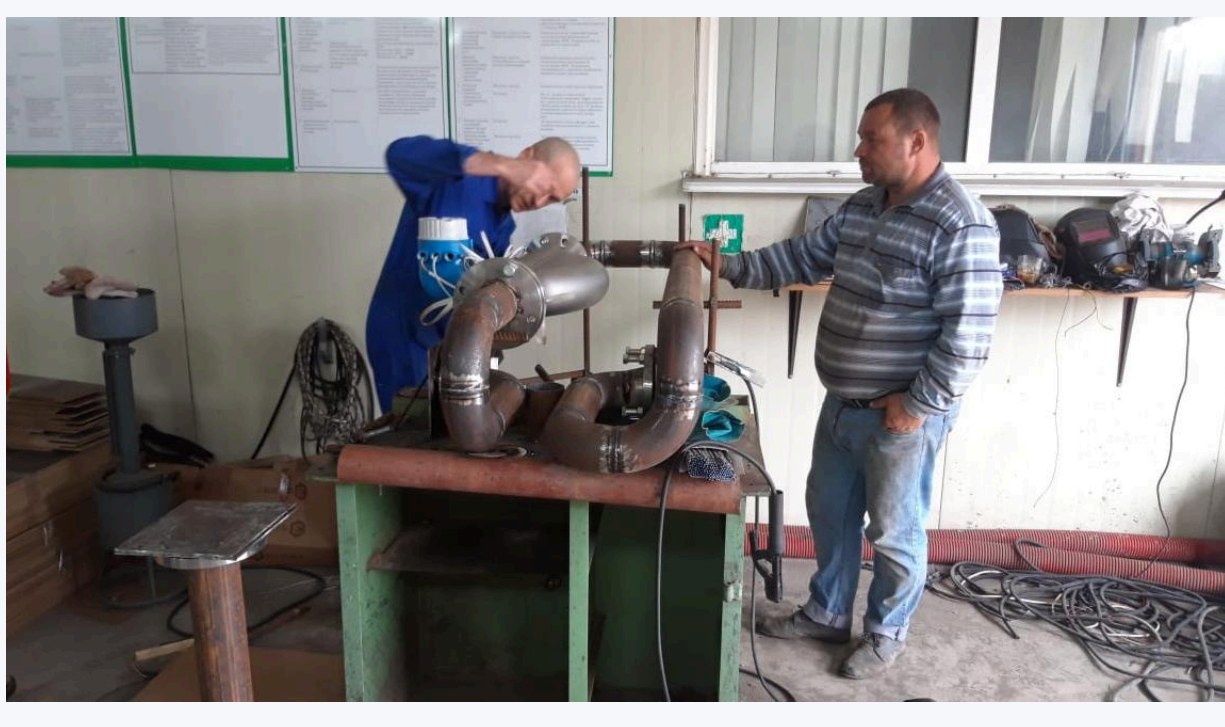
Процесс сварки труб по лекалам в мастерской
