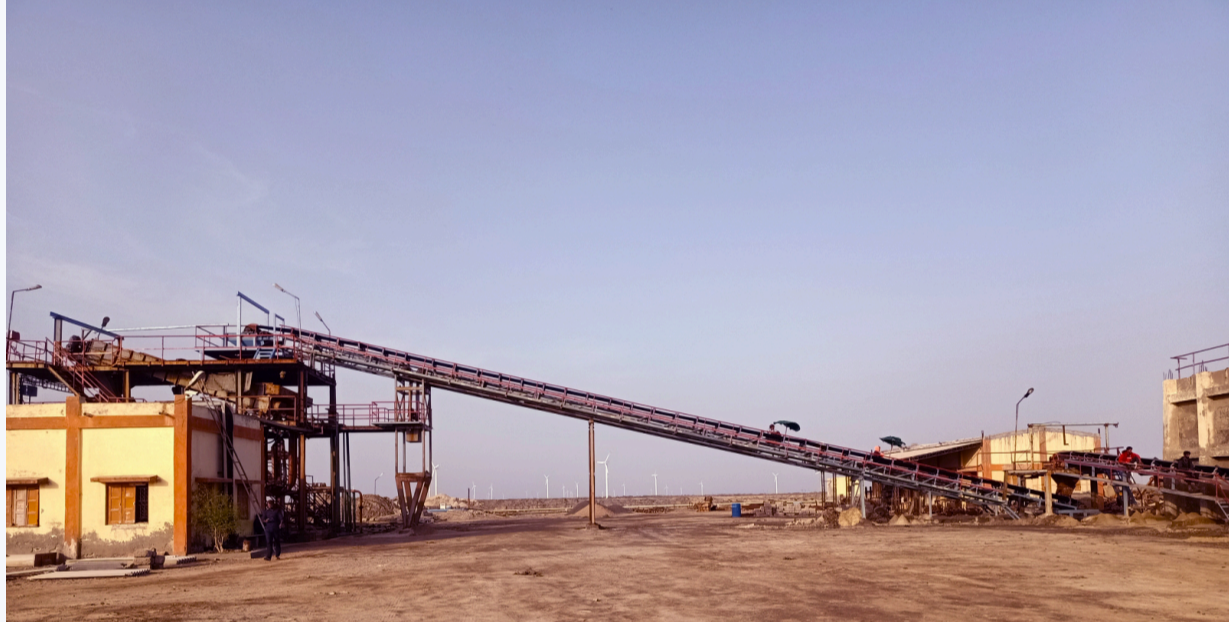
Correias transportadoras com centenas de metros de comprimento, operam 24 horas por dia, 7 dias por semana
