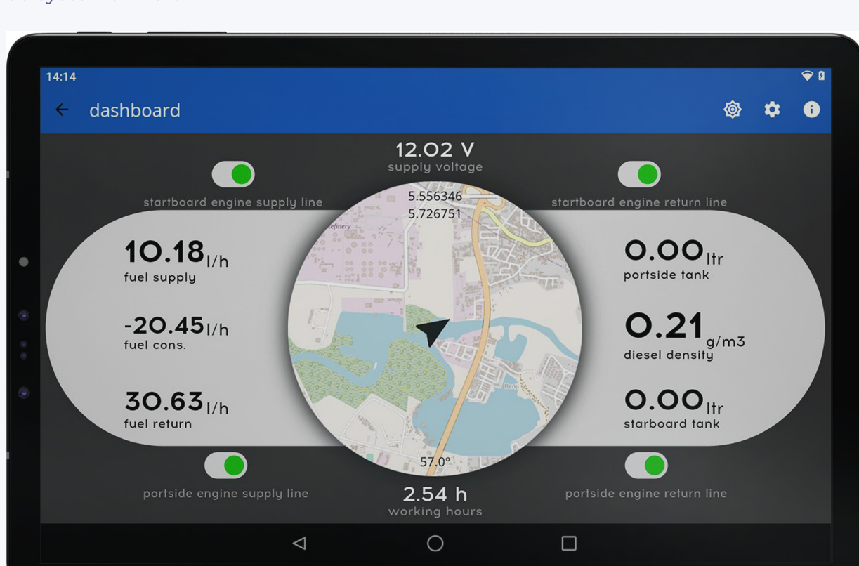
Lorsque l'application est connectée à Internet, les mécaniciens peuvent suivre la consommation de carburant des bateaux en temps réel
