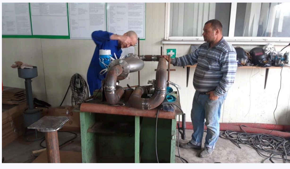
Soudage de tuyaux par gabarits dans l'atelier
