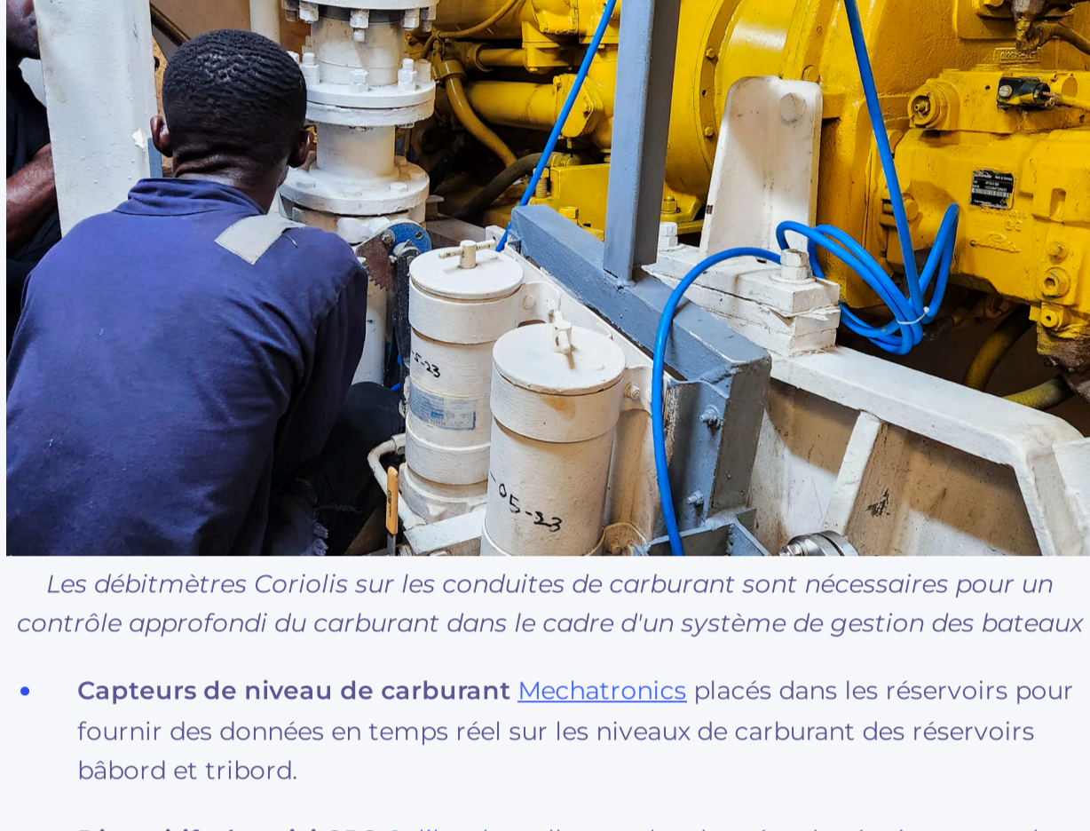
Les débitmètres Coriolis sur les conduites de carburant sont nécessaires pour un contrôle approfondi du carburant dans le cadre d'un système de gestion des bateaux
