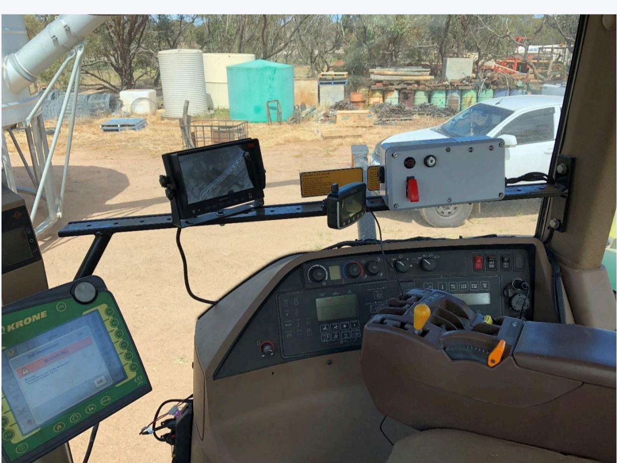
Белая коробка с трекером, считывателем iButton и кнопкой, которую водитель нажимает для регистрации переукладки
