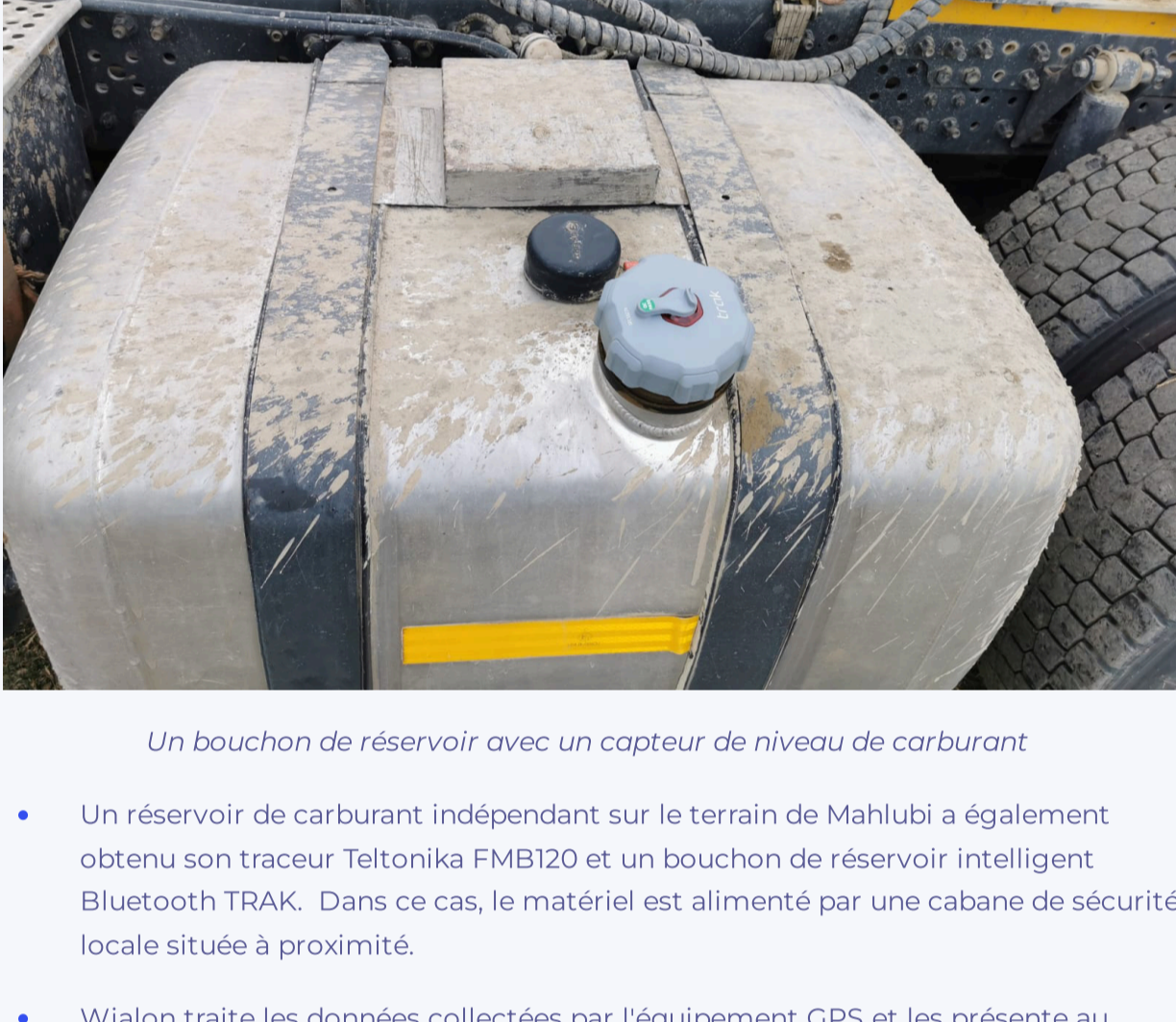
Un bouchon de réservoir avec un capteur de niveau de carburant
