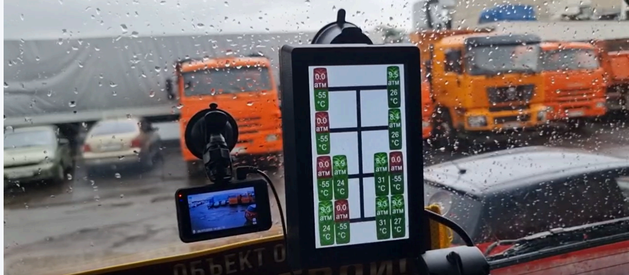
Дисплей отображает данные о состоянии каждого колеса самосвала
