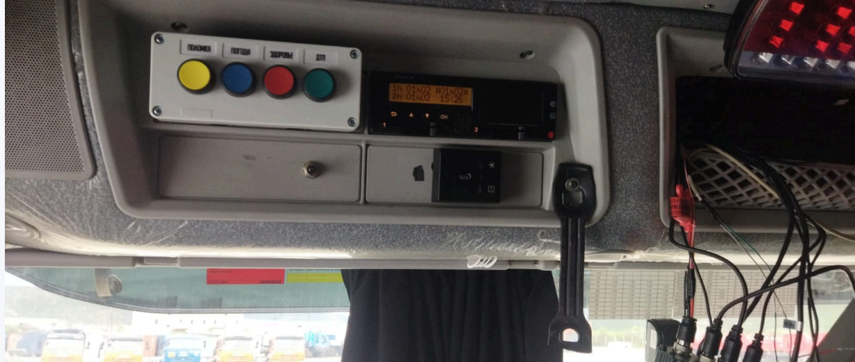
4-кнопочная система оповещения, установленная внутри кабины водителя
