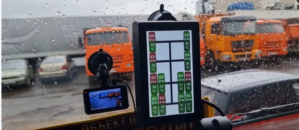
Le tableau de bord affiche les données sur l'état de chaque roue du camion-benne
