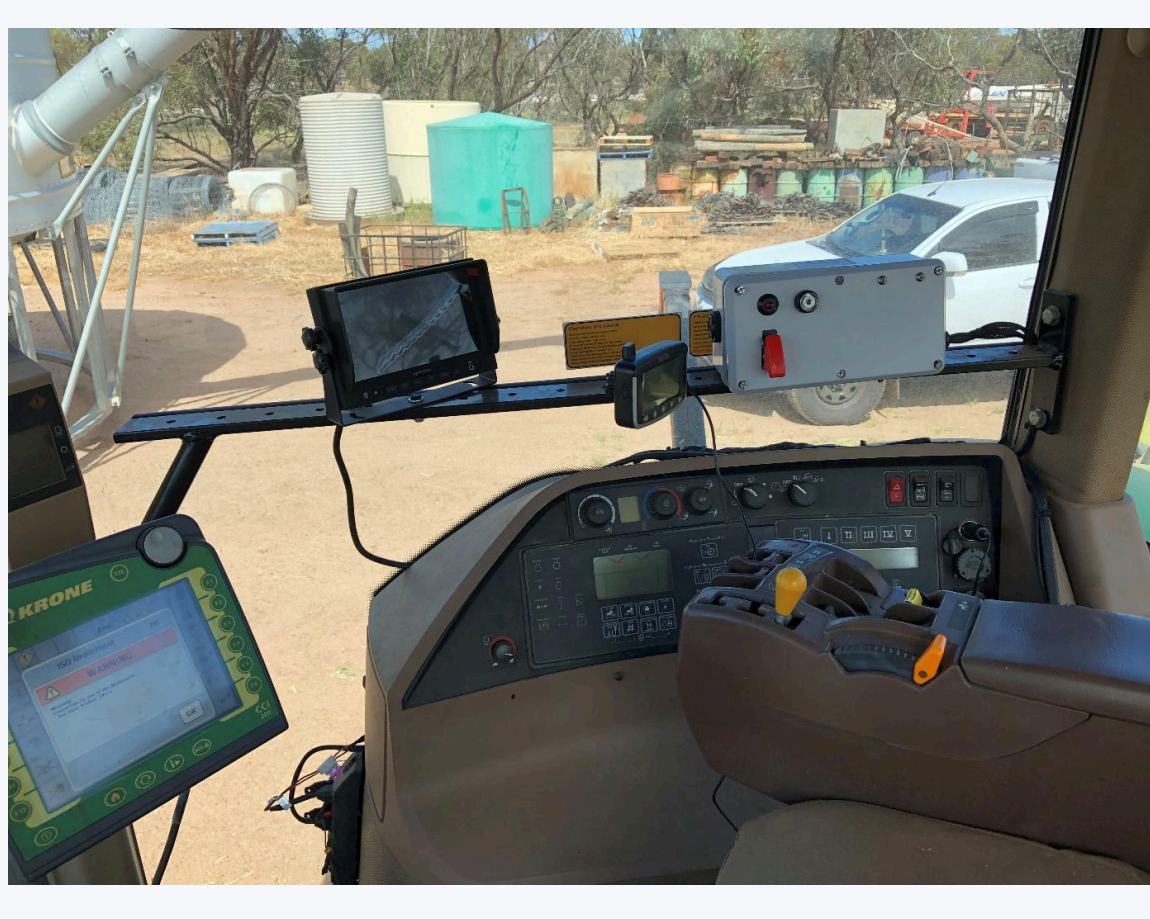
Caja blanca con rastreador, lector iButton y botón que el conductor pulsa para registrar balas descartadas
