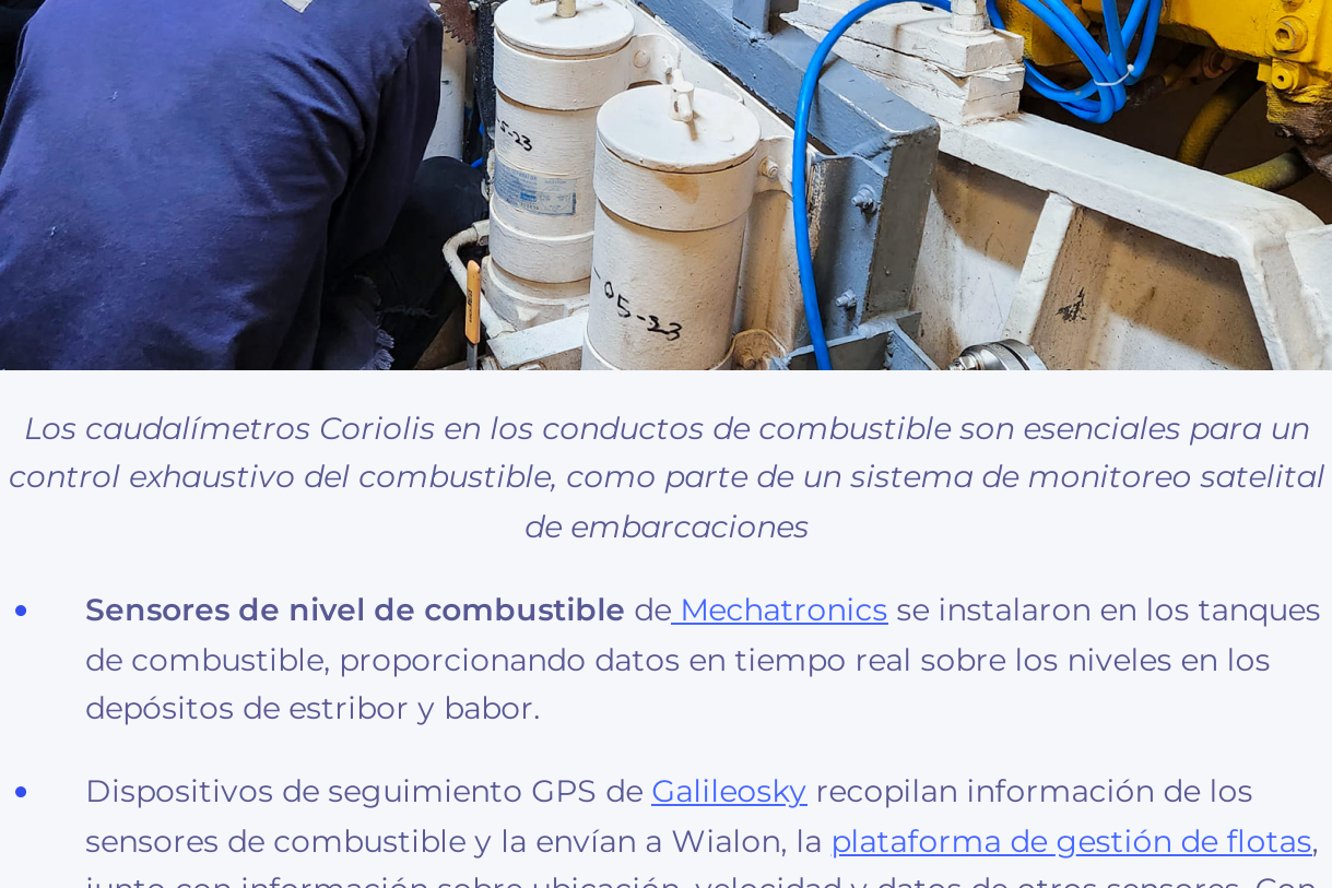
Los caudalímetros Coriolis en los conductos de combustible son esenciales para un control exhaustivo del combustible, como parte de un sistema de monitoreo satelital de embarcaciones
