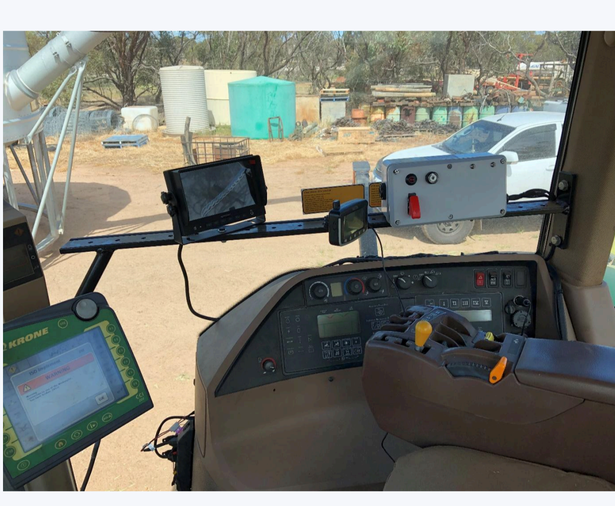
La boîte blanche avec l'appareil de suivi, le lecteur iButton et le bouton pour enregistrer les balles réemballées
