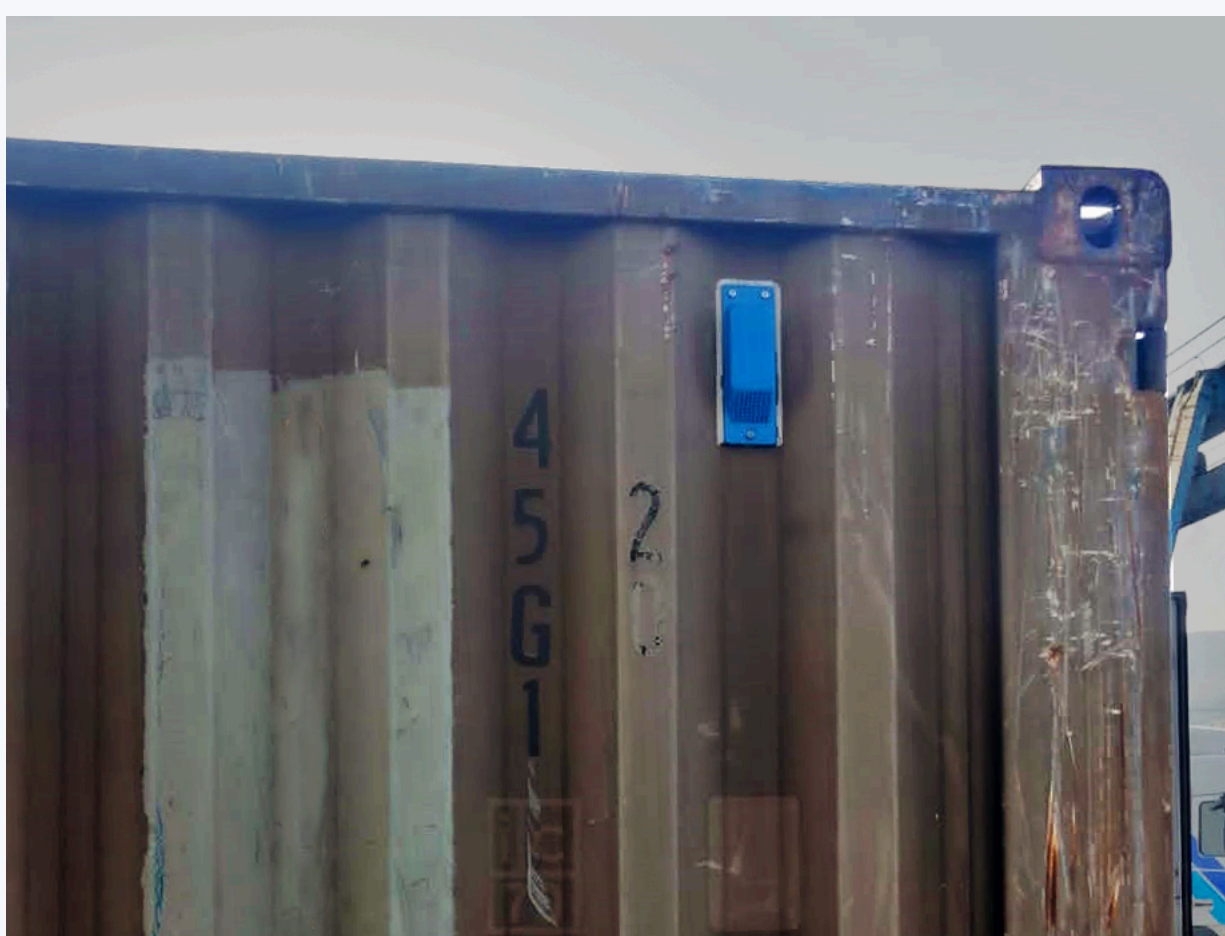
Корпус с телематическим оборудованием внутри, зафиксированный на стенке грузового контейнера
