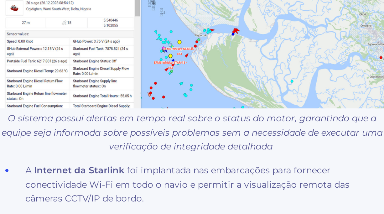
O sistema possui alertas em tempo real sobre o status do motor, garantindo que a equipe seja informada sobre possíveis problemas sem a necessidade de executar uma verificação de integridade detalhada
