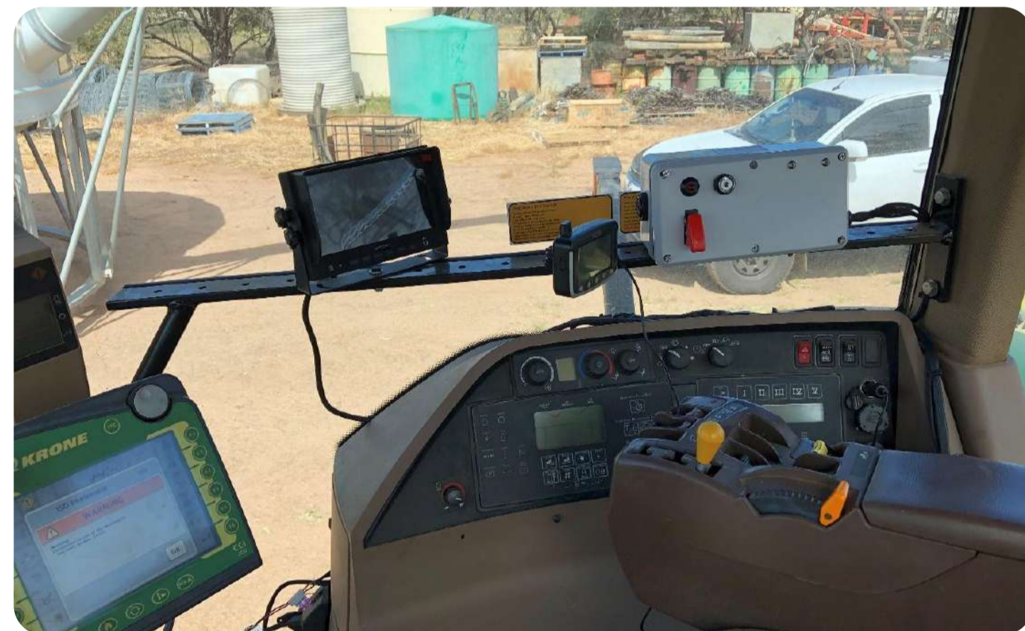
БЕЛАЯ КОРОБКА С ТРЕКЕРОМ, СЧИТЫВАТЕЛЕМ IButton И КНОПКОЙ, КОТОРУЮ ВОДИТЕЛЬ НАЖИМАЕТ ДЛЯ РЕГИСТРАЦИИ ПЕРЕУКЛАДКИ
